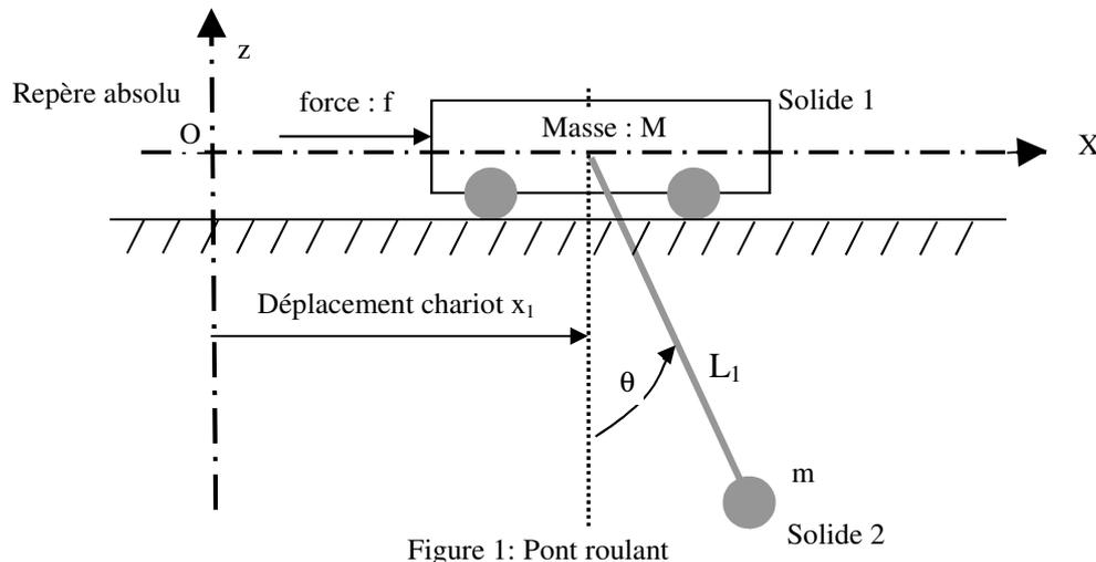
Figure 1: Pont roulant
